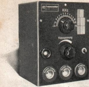
Abb. 1. Frequenzwobler mit Prüfsender und Drucktastenaggregat für Festfrequenzen
